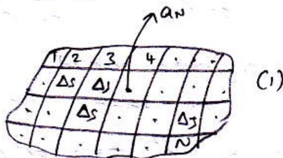
$$\oint \vec{H} \cdot d\vec{l} = \int_1 \vec{H} \cdot d\vec{l} + \int_2 \vec{H} \cdot d\vec{l} + \dots + \int_N \vec{H} \cdot d\vec{l} \quad (1)$$
