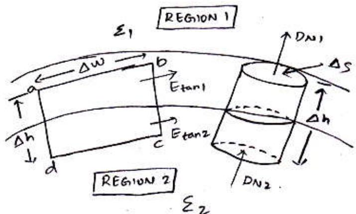
$$\int_a^b \vec{E} \cdot d\vec{l} + \int_b^c \vec{E} \cdot d\vec{l} + \int_c^d \vec{E} \cdot d\vec{l} + \int_d^a \vec{E} \cdot d\vec{l} = 0 \quad \text{--- (2)}$$
